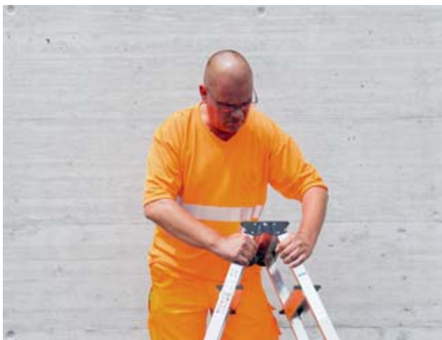
Bild 38: Vor jedem Einsatz: Scharnier prüfen.
