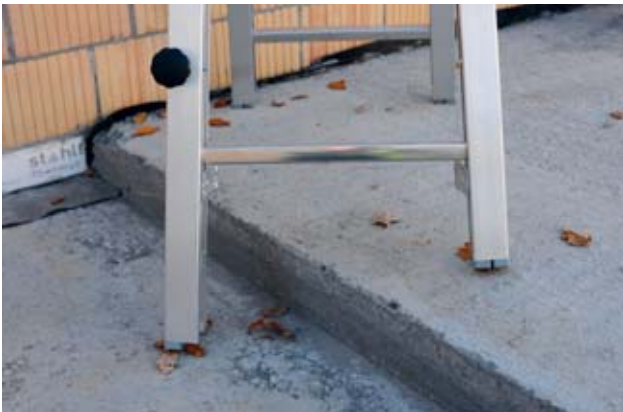
Bild 43: Fussverlängerung, z.B. bei Absätzen
