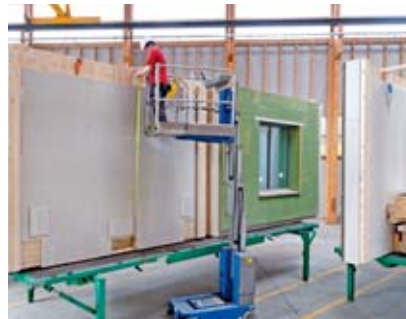
Bild 6: Hubarbeitsbühne, vertikale Bewegungsrichtung
