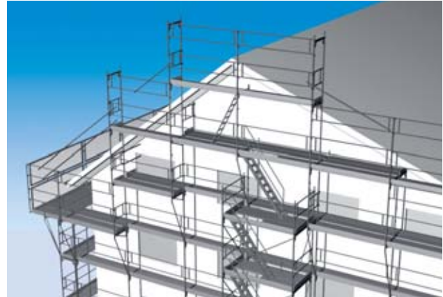
Bild 1 Kollektivschutz in der Bauphase
