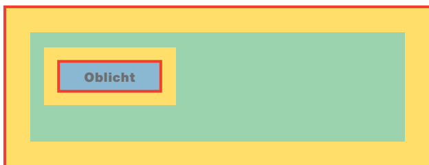
Bild 24 Gefahrenbereiche auf einem Flachdach
