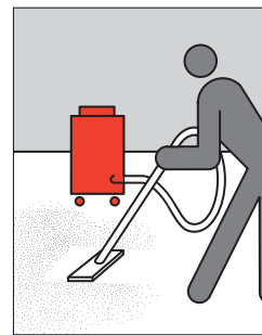
Bild 5: Staub entfernen durch Saugen.
