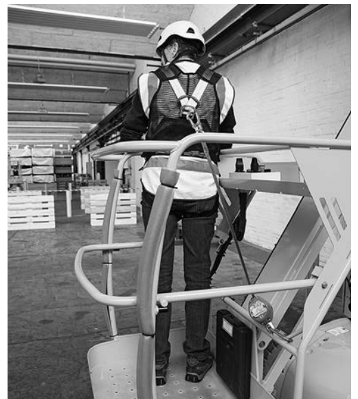
Bild 5: Achtung: Beim Verwenden des Rückhaltesystems nur die zugelassenen Anschlagpunkte benutzen und Verbindungsmittel möglichst kurz halten (Betriebsanleitung beachten).
